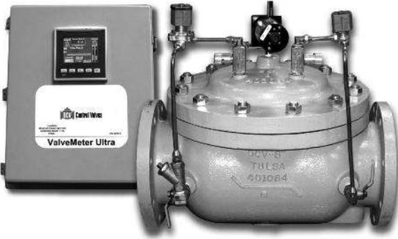
El 22VMU es un sistema de medición y control de flujo, electrónico, auto contenido. Basándose en las variables del diferencial de presión y la posición de la válvula, el ValveMeter Ultra automáticamente calcula, muestra y controla el flujo manteniéndolo en el punto de ajuste de control. Con el ValveMeter Ultra, no hay necesidad de tener un medidor de flujo en la línea.
