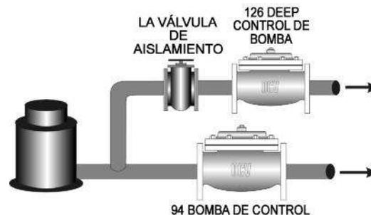
Utilizada junto con el Modelo 126, la Serie 94 brinda protección contra sobrecarga al momento de activación y cierre para bombas de pozos profundos.
