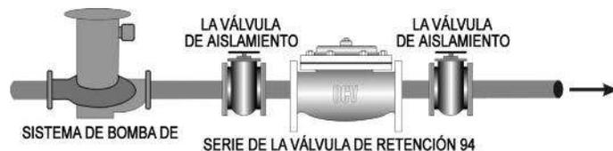
Equipada con una velocidad de apertura controlada, la presión de descarga de la bomba es introducida en el sistema en forma gradual. La bomba está protegida contra el flujo inverso.
