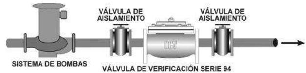
Utilizada junto con el Modelo 126, la Serie 94 brinda protección contra sobrecarga al momento de activación y cierre para bombas de pozos profundos.
