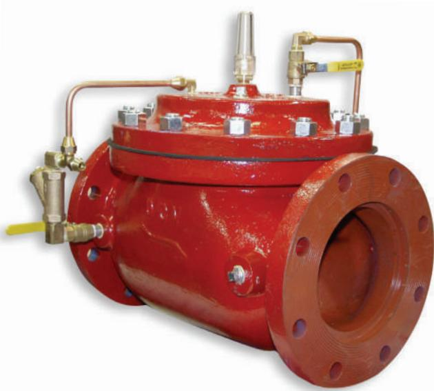
La válvula básica de Control OCV, esférica o angular es una válvula diseñada de puertos completos. Cuando se le dota de una variedad de pilotos y accesorios, la válvula realiza una amplia gama de controles automáticos de fluidos, haciendo de ella una válvula especializada en sistemas de agua municipal, sistemas contra incendios, irrigación, industria, petróleo y sistemas de combustible de aviación.
