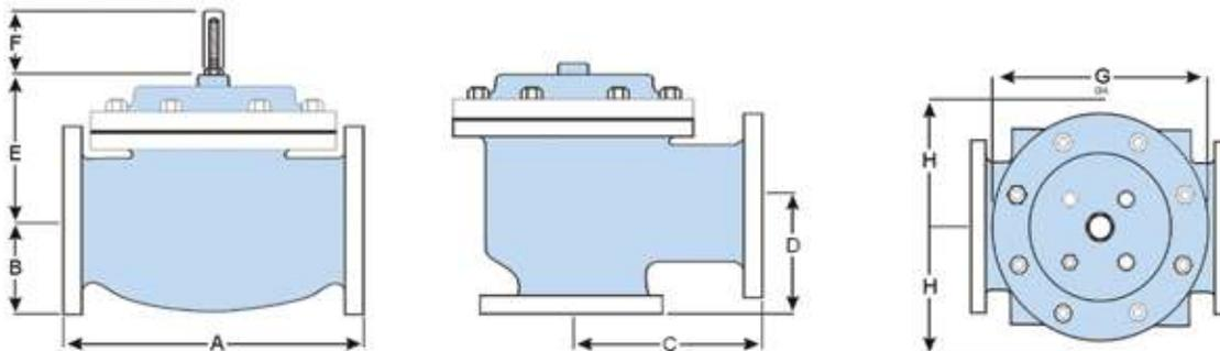
Para mayor eficiencia, la válvula de control de OCV deberá montarse en un sistema de tuberías de manera que la tapa (cubierta) esté en la posición superior. Otras posiciones son aceptables pero pueden impedir que la válvula funcione al máximo de su potencial y con óptima seguridad. Para casos específicos, consulte con la fábrica antes de instalar válvulas mayores de 8", o cualquier otro tipo con interruptores de límite de carrera en posiciones que difieren de las descritas.
