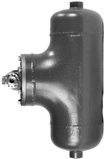
El piloto flotante modelo 815 es un diseño de dos vías, de disco giratorio, apropiado de forma primaria para el servicio de combustibles con tanques de techo flotante. También puede ser utilizado en todos los casos en que el acceso al tanque interior esté restringido o sea imposible. Apropiado para el servicio de modulación y encendido-apagado.
